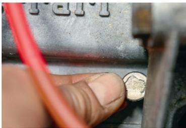
Besonders im Motorraum muss man sicherstellen, dass der Untergrund fettfrei ist. Es kann helfen, den Chip zusätzlich mit Panzertape zu sichern
