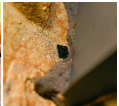
Wenn der Wagen wie in unserem Fall teilweise zerlegt ist, eröffnen sich weitere Möglichkeiten. Zwei der kleinen PET-Chips verschwinden unter Leder und Dämmmaterial im Innenraum
